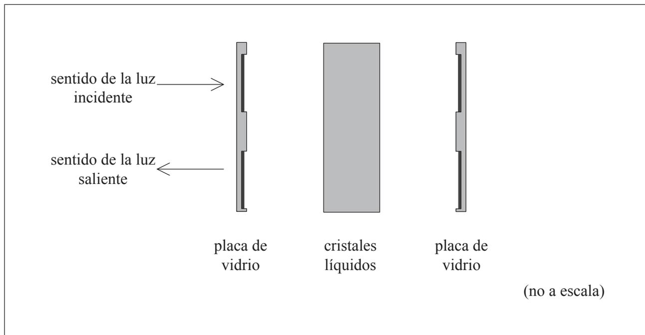
El LCD incluye también dos láminas polarizadoras y una superficie reflectante.
