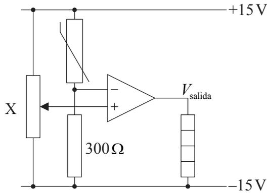
El circuito se utiliza para controlar la temperatura en un invernadero. La resistencia de un termistor decrece al aumentar su temperatura.
